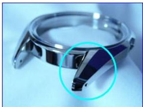
圖 4-7 結合電腦控制技術拋光加工後的手錶外殼三次元曲面
